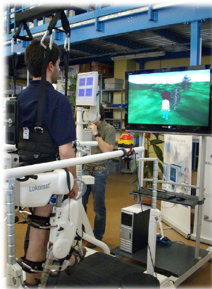
Sistema robotico Lokomat (Hocoma AG, Switzerland) con sistema di Realtà Virtuale
